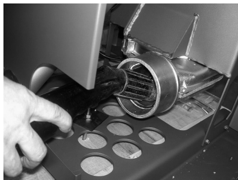
Image 9 – Nettoyage du boîtier du ventilateur de fumées
