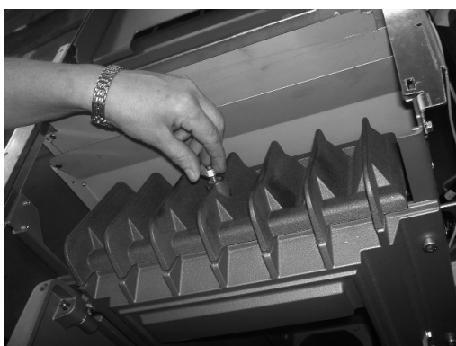
Illustration 4 – Ouverture de l'écrou à ailettes
