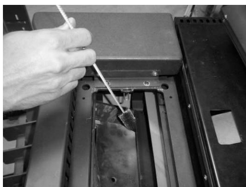
Illustration 6 - Voies latérales d'échappement de la fumée à côté du foyer
